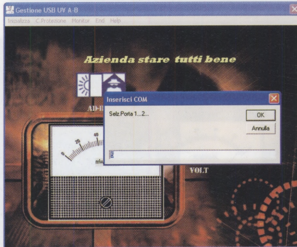
Fig.27 Per attivare questa applicazione, selezionate preventivamente la porta di comunicazione com del vostro pc e cliccate su Ok.
